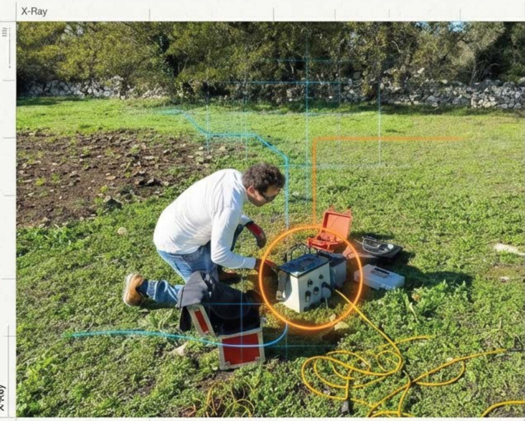
**Il Metodo:** Immettiamo corrente nel terreno per misurare la resistività.
